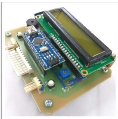
Gambar 14. Bentuk fisik modul *master*
