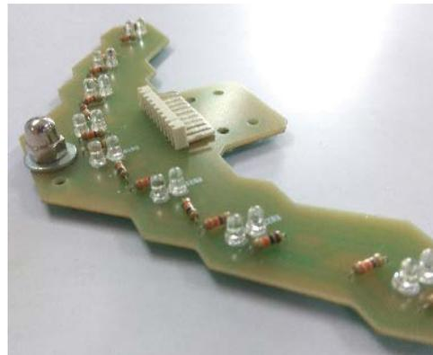
Gambar 15. Bentuk fisik modul sensor cahaya
