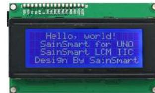
Gambar 5 LCD 20x4
