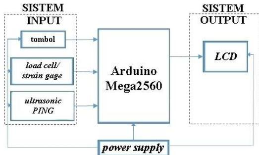
Gambar 7 Diagram blok alat pengukur berat dan dimensi paket
