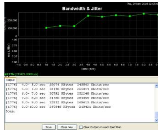
Gambar 18. Simulasi traffic dari server ke client tanpa VRRP
