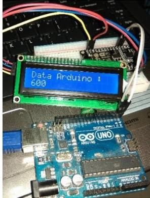
Gambar 13. Hasil pengujian komunikasi serial
