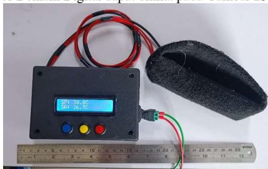
Gambar 23. Fisik Alat Kompres Demam Digital
