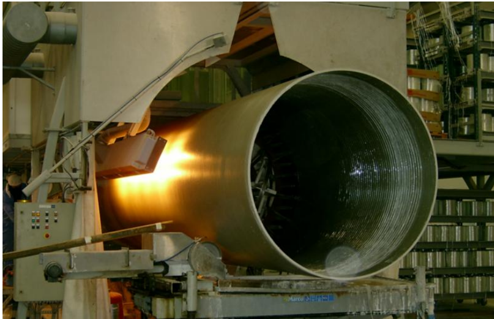
Gambar 2. Proses Produksi GRP Pipe
