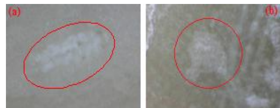
Gambar 5. Cacat wrinkle (a) dan resin pocket (b)
