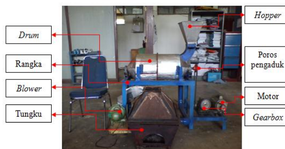
Gambar 1. Alat Pengering Padi Tipe Drum Dryer Dengan Mekanisme Pengaduk
