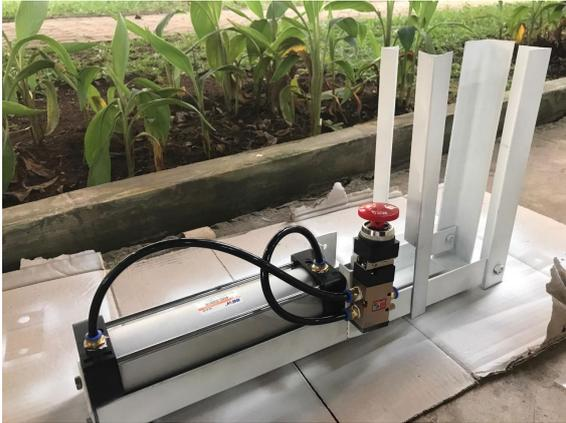
Gambar 4. Mesin penghancur kaleng berbasis sistem pneumatik
