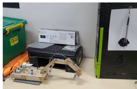
Gambar 7. Pengujian Beban Maksimum pada Excavator
