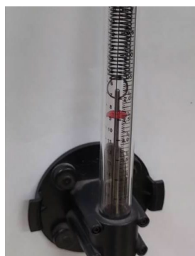
Gambar 9. Pengukuran Beban Maksimum Motor DC dan Gearbox Kedua
