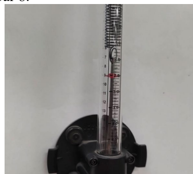
Gambar 8. Pengukuran Beban Maksimum Motor DC dan Gearbox Pertama
