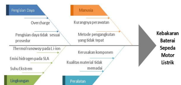
Gambar 2. Diagram fishbone – kebakaran baterai sepeda motor listrik
