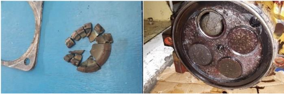
Gambar 4. Valve exhaust yang pecah dan cylinder head yang cacat
