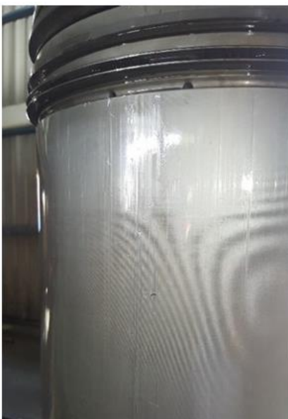
Gambar 6. Piston yang mengalami scratch ringan
