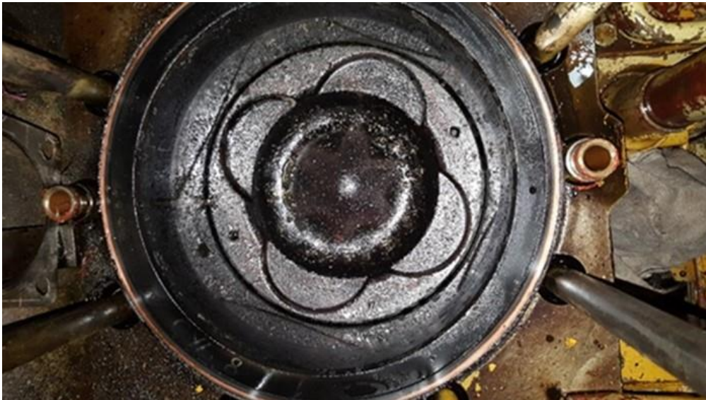
Gambar 5. Crown piston mengalami cacat akibat benturan dengan pecahan valve
