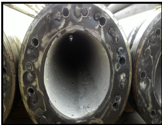
Gambar 7. Visual dalam Tiang Pancang Mutu K.600 + CTF-9A
