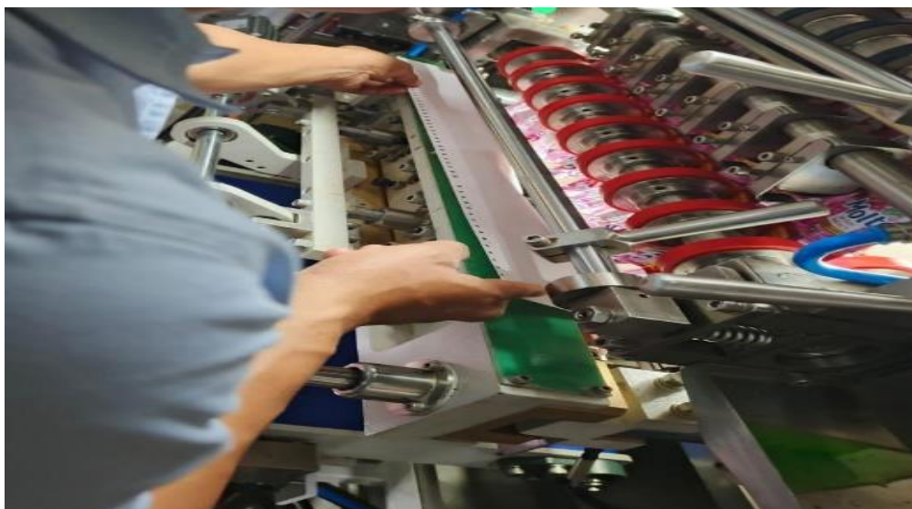
Gambar 2. Proses tekan plastik Fuji Film di unit Sealer.
