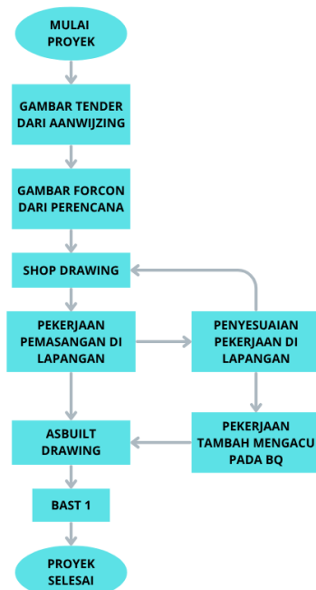
Gambar 2. Alur Pemasangan Instalasi Plumbing DP Mall Expansion
