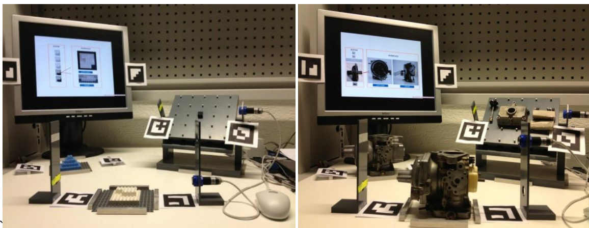
Gambar 1. Lingkungan studi perakitan menggunakan (a) brik LEGO (b) karburator
