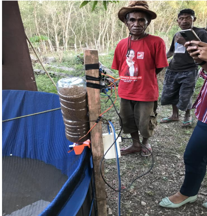
Gambar 6. Pemasangan komponen IoT sistem pakan otomatis dan kontrol kekeruhan air
