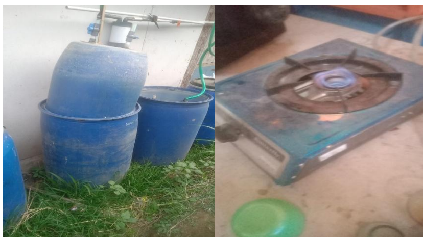
Gambar 8. Penampung biogas drum
