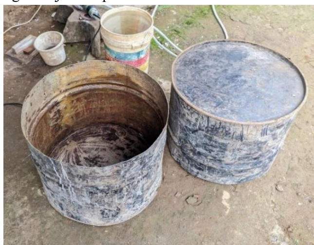
Gambar 3. Drum dipotong menjadi dua bagian
