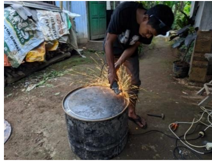
Gambar 6. Pemotongan tutup drum bagian luar
