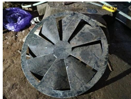
Gambar 7. Alas pembakaran sekaligus ventilasi udara bagian bawah
