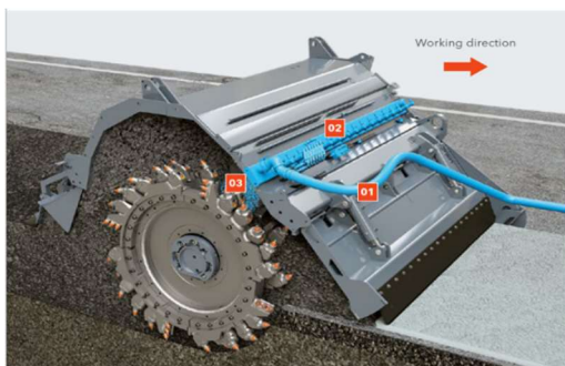
Gambar 9. Proses pencampuran dengan alat Recycler [9]
